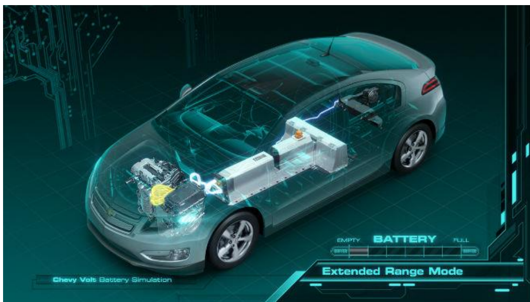
รูป 2-6 การจัดวางชิ้นส่วนรถยนต์ไฟฟ้า (ที่มา: General Motor)
