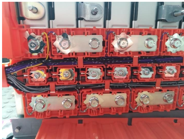
รูป 3-30 หัวต่อสำหรับวัดแรงดันไฟฟ้าแต่ละเซลล์แบตเตอรี่ (ที่มา: MTEC)
