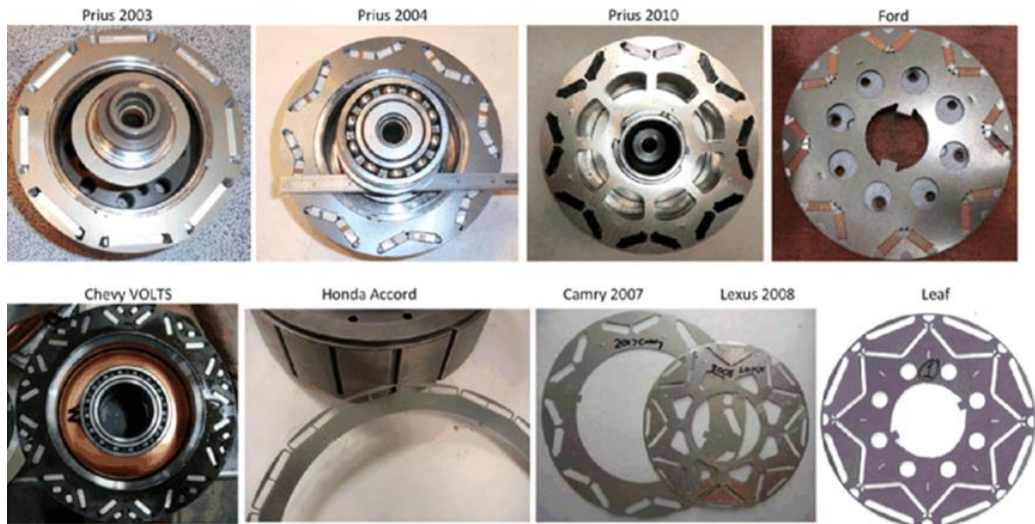
รูป 3-11 Rotor lamination ในมอเตอร์ของรถยนต์ไฟฟ้ารุ่นต่างๆ (ที่มา: Bulent Sarlioglu)
