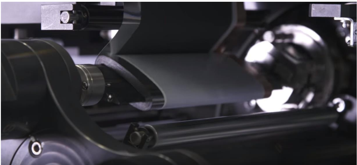
รูป 4-15 การพันอิเล็กโทรดในขั้นตอนการประกอบแบตเตอรี่ (ที่มา: Gommeblog.it) [5.4]
