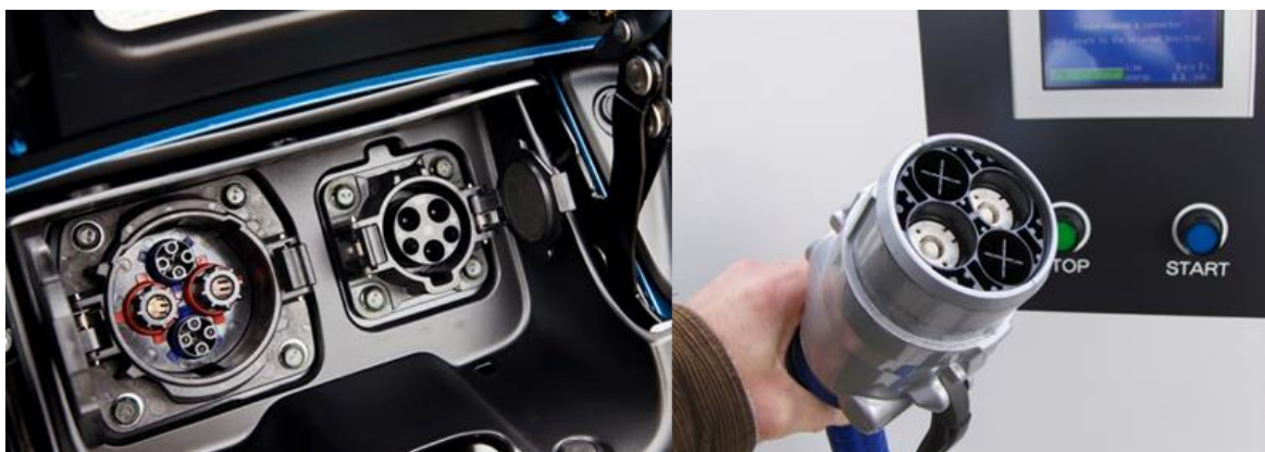
รูป 3-33 ช่องหัวรับไฟ (Inlet) สำหรับการชาร์จของรถนิสสันลิฟ [4.13]
