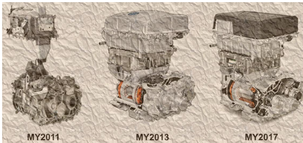
รูป 3-3 เปรียบเทียบระบบส่งกำลังของรถยนต์นิสสันลิฟรุ่นโมเดลต่างๆ (ที่มา : MTEC)
