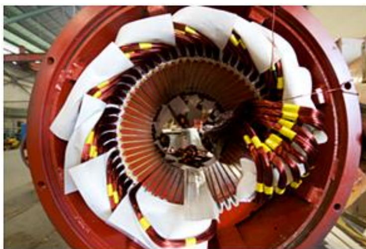
รูป 4-5 Wire inserting
