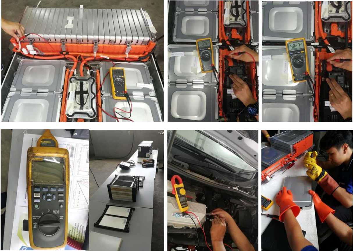
รูป 3-51 การทดสอบแบตเตอรี่รถยนต์นิสสันลีฟ
