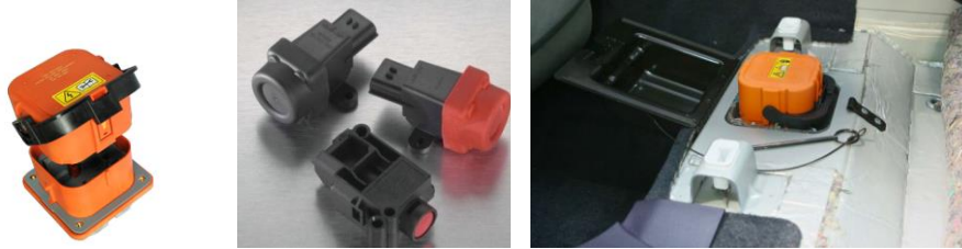
รูปที่ 13 Manual Service Disconnect , Crash Switch และตำแหน่งติดตั้งของ MSD ที่ใต้เบาะหลัง [6]
