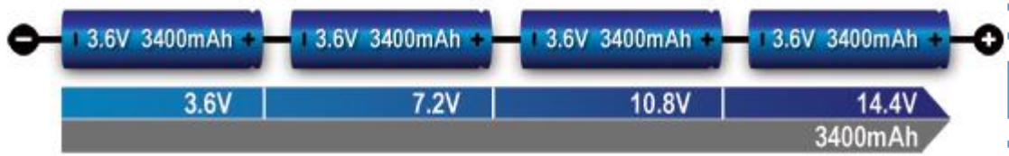
รูปที่ 36 การเชื่อมต่อและการคำนวณของการเชื่อมต่อแบบอนุกรม
