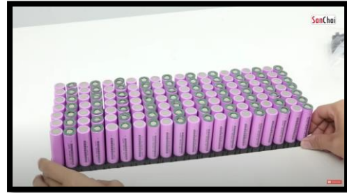
รูปที่ 46 ประกอบเซลล์แบตเตอรี่ลงในรางบล็อกเปลี่ยน
