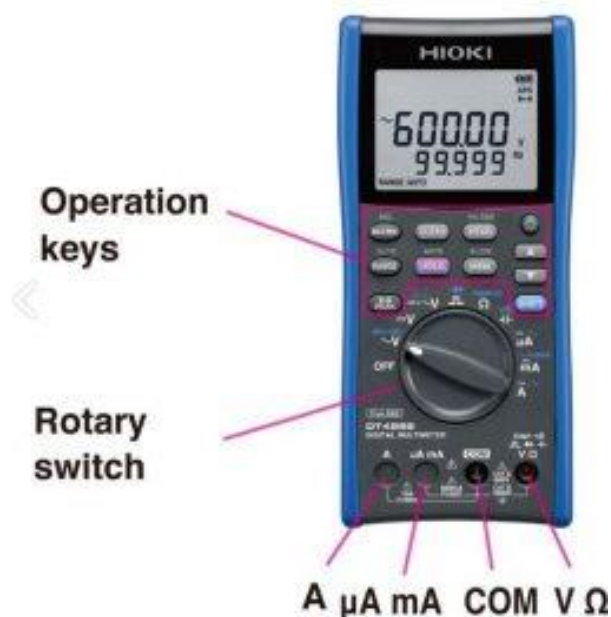
รูปที่ 28 มัลติมิเตอร์ Hioki Model: DT-4282
