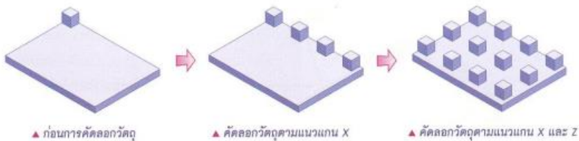
รูปที่ 1 : วัตถุที่ผ่านการตัดลอกด้วย Linear Pattern
