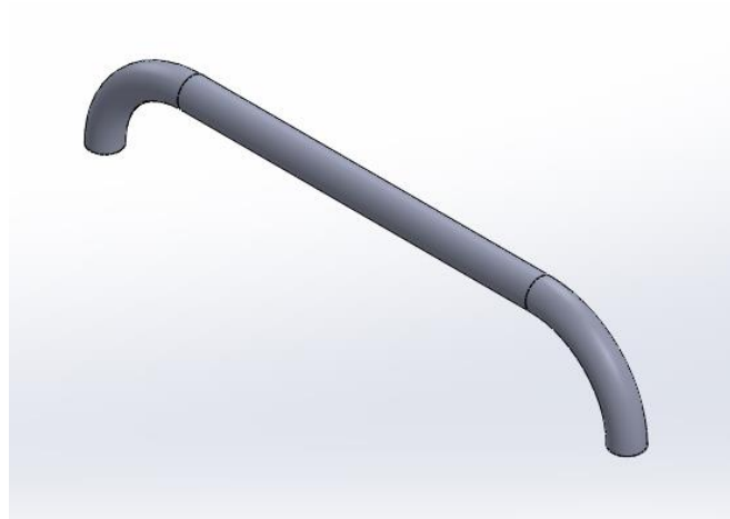
ภาพที่ 6 สร้างวัตถุด้วย Swept Boss/Base
