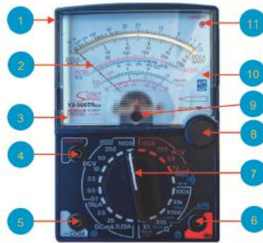
รูปที่ 2.2 มัลติมิเตอร์ชนิดเข็ม YX-360TRE-B
