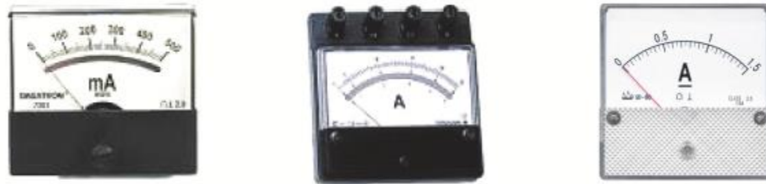
รูปที่ 5.21 ตัวอย่างมิลลิแอมมิเตอร์และแอมมิเตอร์ไฟฟ้ากระแสตรง
