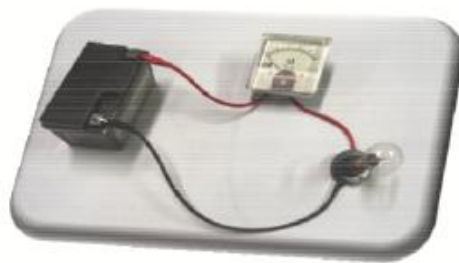
(ก) ตัวอย่างการต่อแอมมิเตอร์เพื่อวัดกระแสไฟฟ้า (ข) วงจรการต่อแอมมิเตอร์เพื่อวัดกระแสไฟฟ้า
