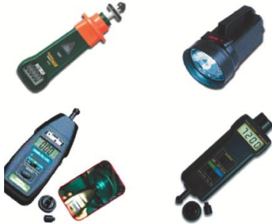
รูปที่ 9.6 ตัวอย่างเครื่องวัดความเร็วรอบและการใช้งาน
