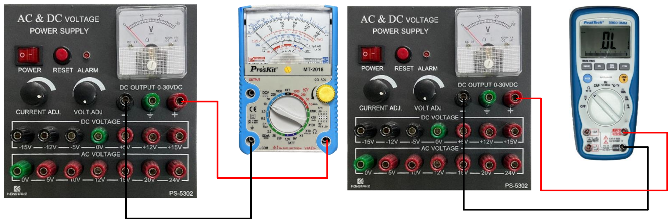
รูปที่ 3.2 การวัดแรงดันไฟฟ้า
