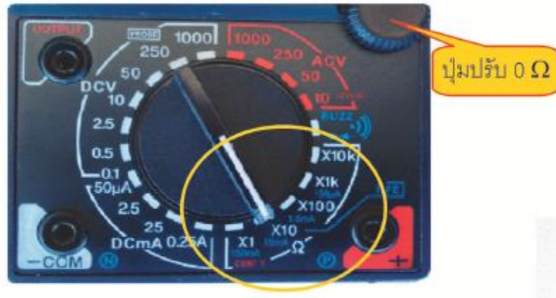
รูปที่ 2.12 ย่านวัดโอห์มของมัลติมิเตอร์ขั้วกรุ่น YX-360TRE-B
