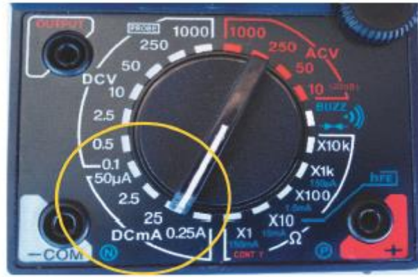
รูปที่ 2.9 ย่านวัด DCmA ของมัลติมิเตอร์รุ่น YX-360TRE-B
