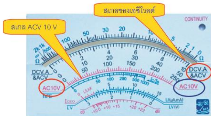
รูปที่ 2.8 สเกลของเอซีโวลต์มิเตอร์ของมัลติมิเตอร์
