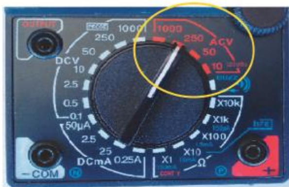
รูปที่ 2.7 ย่านวัด ACV ของมัลติมิเตอร์รุ่น YX-360TRE-B
