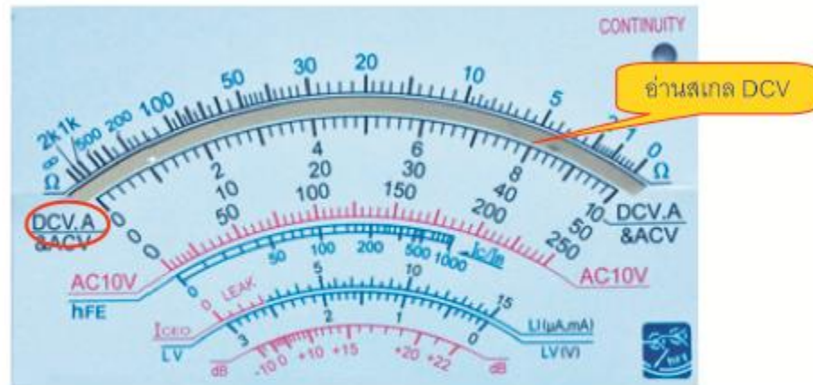
รูปที่ 2.6 สเกลของดีซีโวลต์มิเตอร์ของมัลติมิเตอร์
