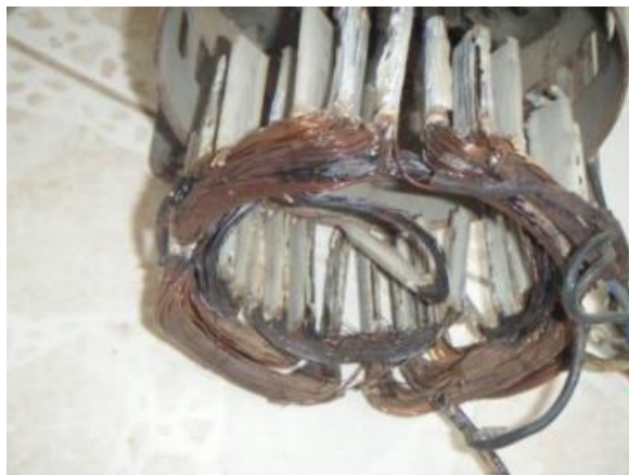
รูปที่ 2.5 ขดลวดที่หลุดออกจากสเตเตอร์
