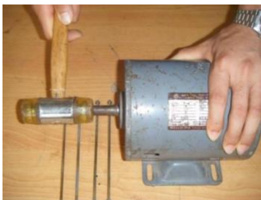
รูปที่ 2.2 การใช้ค้อนพลาสติกตอกที่เพลลามอเตอร์
