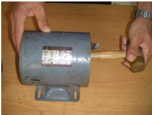
รูปที่ 2.3 การใช้ค้อนกระทุ้งฝาปิดมอเตอร์
