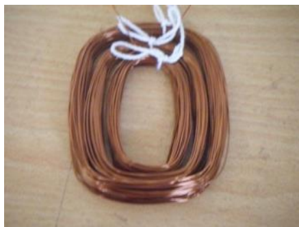
รูปที่ 3.1 การพันขดลวดทองแดงบนฟอร์มคอยล์
