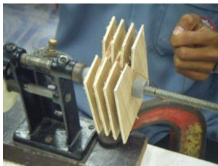
รูปที่ 3.1 การพันขดลวดทองแดงบนฟอร์มคอยล์
