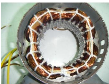
รูปที่ 3.3 การลงขดรีนและขดสตาร์ท
