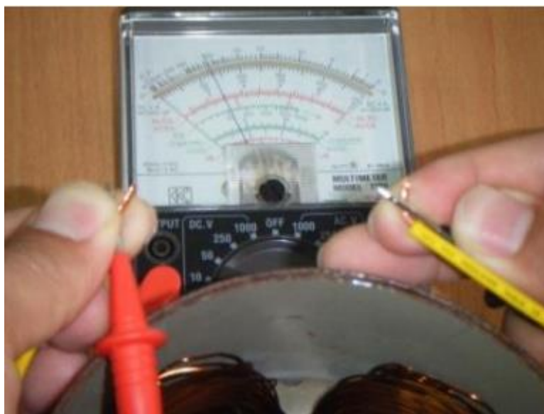
รูปที่ 4.8 การวัดความต้านทานขดลวดมอเตอร์
