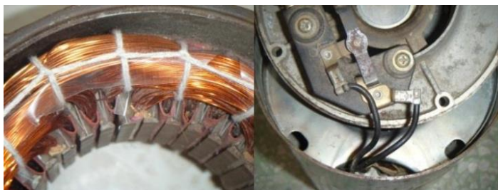
รูปที่ 4.9 การมัดเชือกและฝือปลายสายสวิตช์แรงเหวี่ยง
