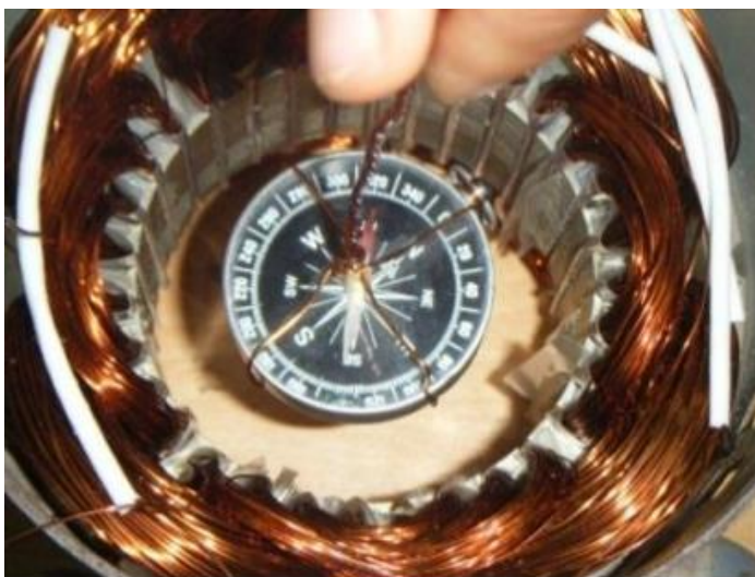
รูปที่ 4.6 การใช้เข็มทิศตรวจสอบขั้วแม่เหล็ก
