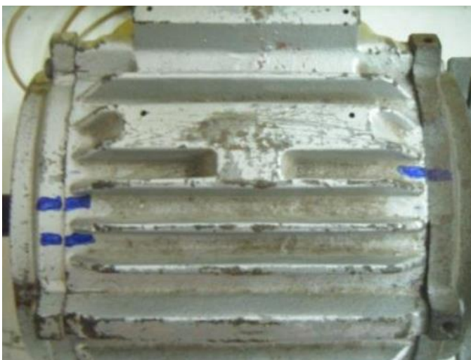
รูปที่ 11.1 การทำเครื่องหมายที่ฝาปิดกับโครงสเตเตอร์
