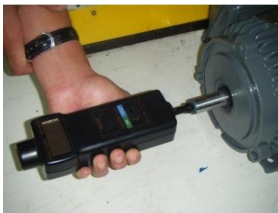
รูปที่14.2 การวัดความเร็วรอบมอเตอร์
