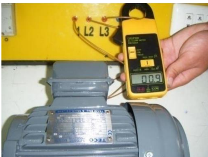
รูปที่ 14.1 การทดสอบกระแสมอเตอร์
