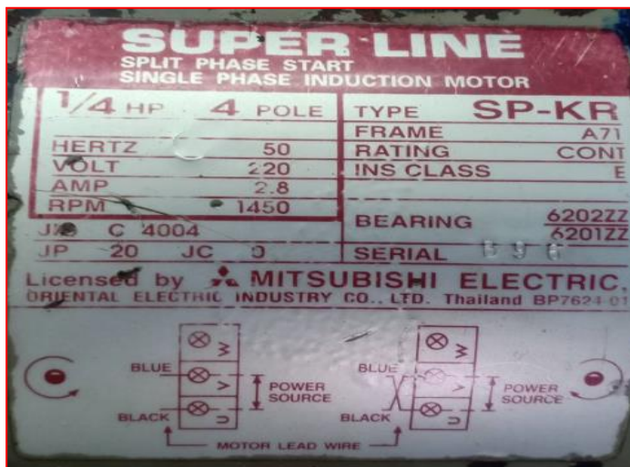
รูปที่ 1.1 แผ่นป้าย(Name plate) ของมอเตอร์ตัวที่ 1
