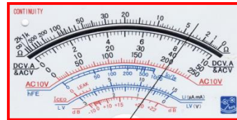
รูปที่ 1 ค่าความต้านทานเมื่อวัดไบแอสตรง
