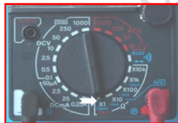
รูปที่ 1 ค่าความต้านทานเมื่อวัดไบแอสตรง
