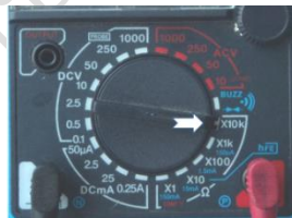
รูปที่ 2 ค่าความต้านทานเมื่อวัดไบแอสกลับ
