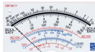
รูปที่ 2 ค่าความต้านทานเมื่อวัดไบแอสกลับ
