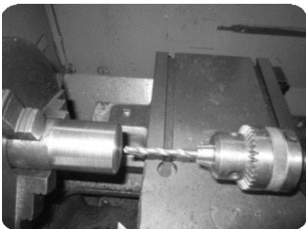
รูปที่ 1.41 เจาะรูนำศูนย์ด้วยดอกสว่านขนาดเล็ก
