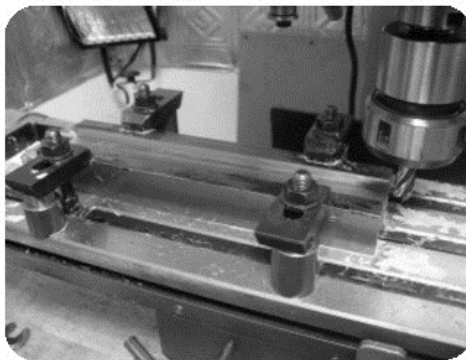
รูปที่ 2.37 การกัดร่องด้วยดอกกัดเอ็นมิลล์ที่มีการกัดขยายขนาด
