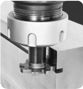
รูปที่ 2.23 การกัดร่องด้วยดอกกัด Side Milling Cutter
