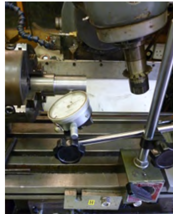
รูปที่ 4.8 การวัดแนวศูนย์กลางในการกัดเฟืองเฉียง
