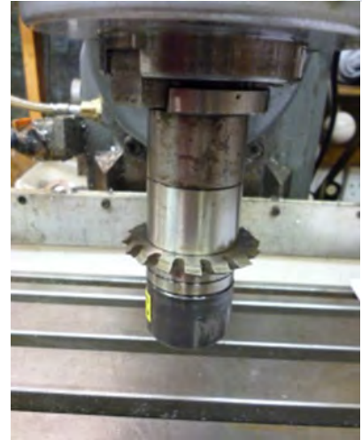
รูปที่ 4.1 การจับดอกกัดด้วยแกนเพลลาจับยึด ซึ่งติดตั้งอยู่ในตัวยึดบนหัวเครื่องในแนวตั้ง
