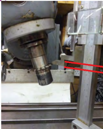
รูปที่ 4.4 การวัดความสูงด้านบนของดอกกัด
