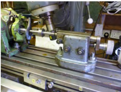
รูปที่ 4.10 การประกอบเครื่องมือและอุปกรณ์ต่าง ๆ สำหรับการกัดเฟืองเฉียง
