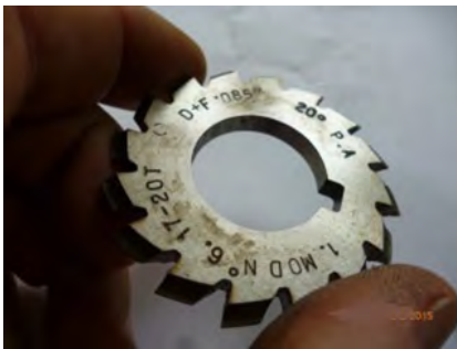
รูปที่ 4.3 ดอกกัดแบบบราวน์แอนด์ชาร์ปที่ใช้ในตัวอย่าง
