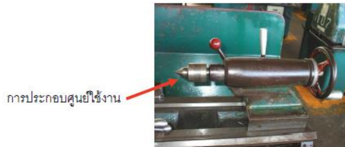
รูปที่ 1.17 ลักษณะโครงสร้างของศูนย์หมุนเครื่องกลึงและการประกอบใช้งาน
