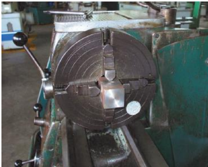
รูปที่ 1.37 ลักษณะการจับชิ้นงานกลึงด้วยหัวจับแบบ 4 จับพื้นอิสระ
