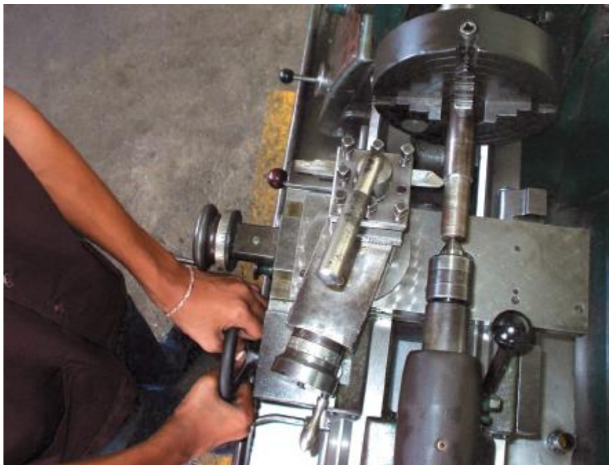
รูปที่ 1.38 ลักษณะการจับชิ้นงานกลึงด้วยหัวจับและยันศูนย์ท้ายแทน
