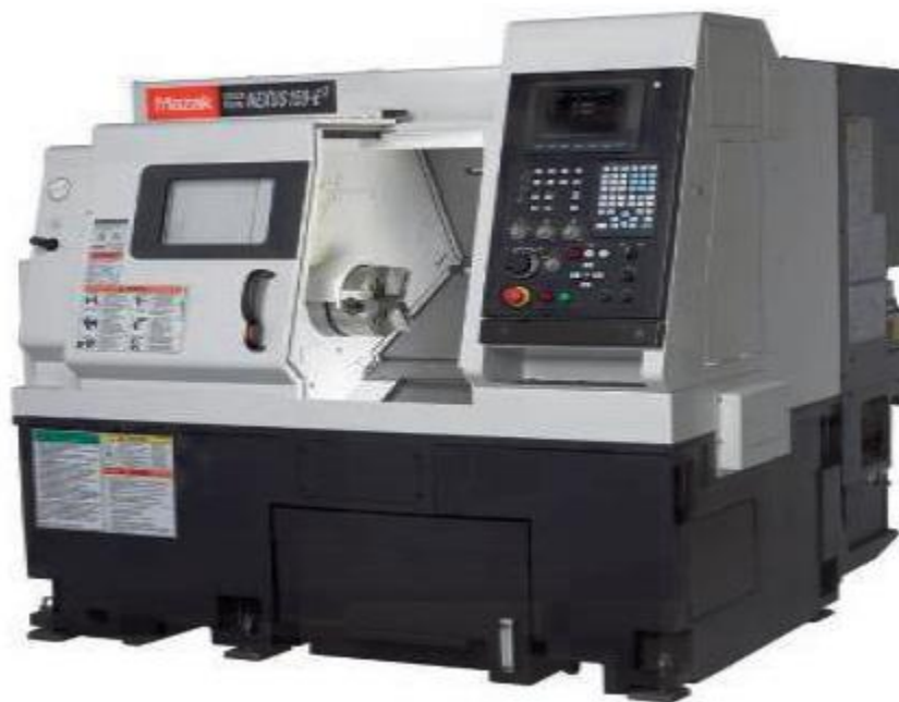
รูปที่ 1.5 รูปร่างลักษณะของเครื่องกลึง CNC
