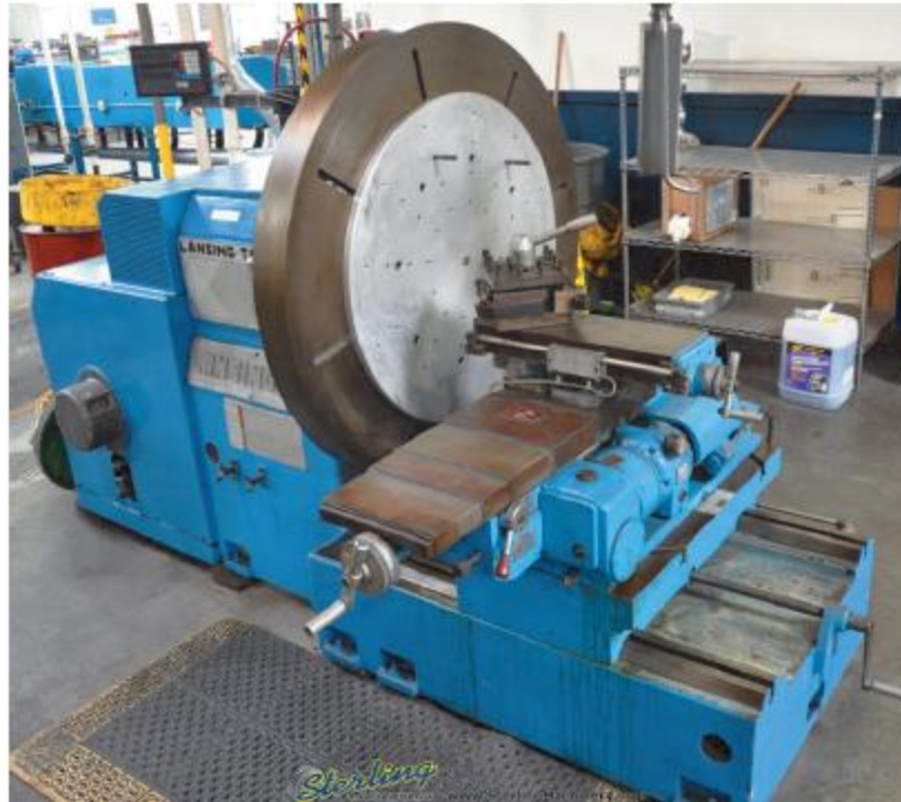
รูปที่ 1.3 รูปร่างลักษณะของเครื่องกลึงหน้าจาน
