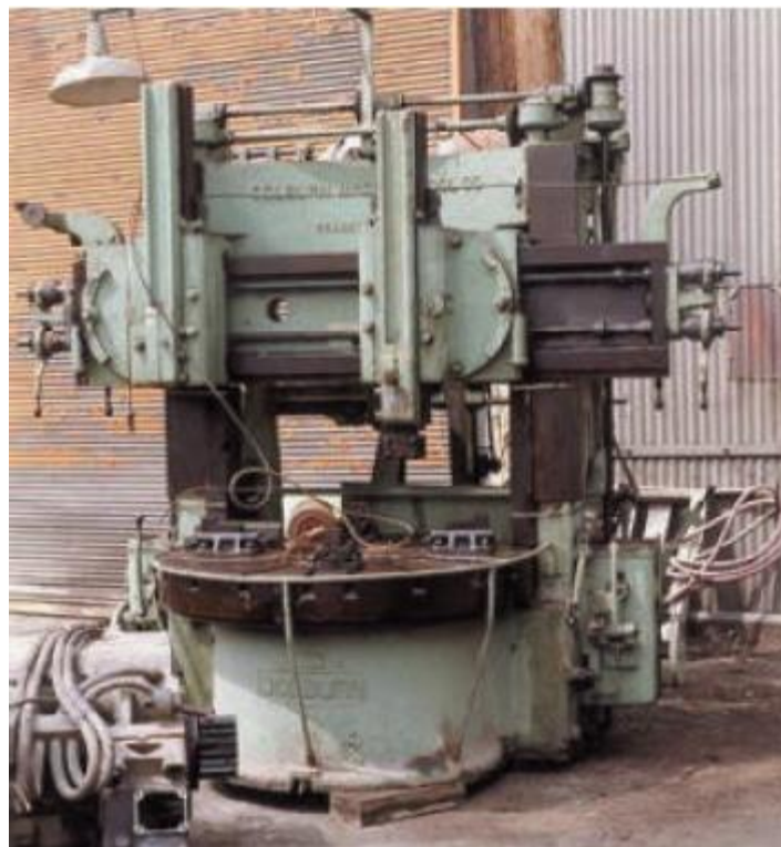
รูปที่ 1.2 รูปร่างลักษณะของเครื่องกลึงตั้ง
