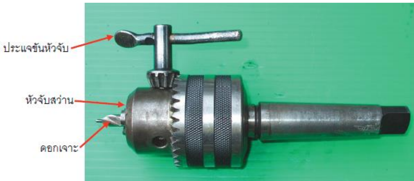
รูปที่ 1.41 รูปร่างลักษณะของส่วนประกอบของดอกเจาะด้วยเครื่องกลึงแบบย้อนศูนย์
