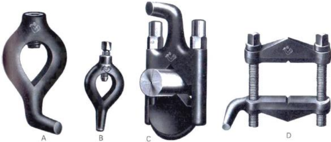
รูปที่ 1.15 รูปร่างลักษณะของห่วงพาเครื่องกลึง
