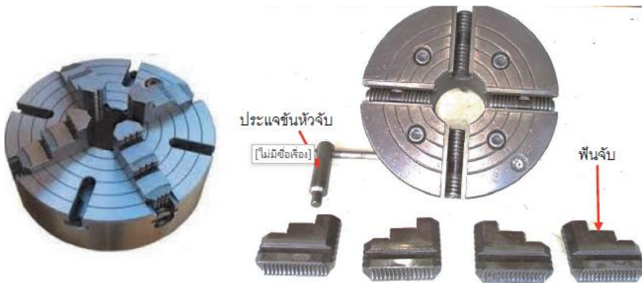
รูปที่ 1.13 รูปร่างลักษณะและการขันพื้นจับของหัวจับแบบ 4 จับพื้นอิสระ
