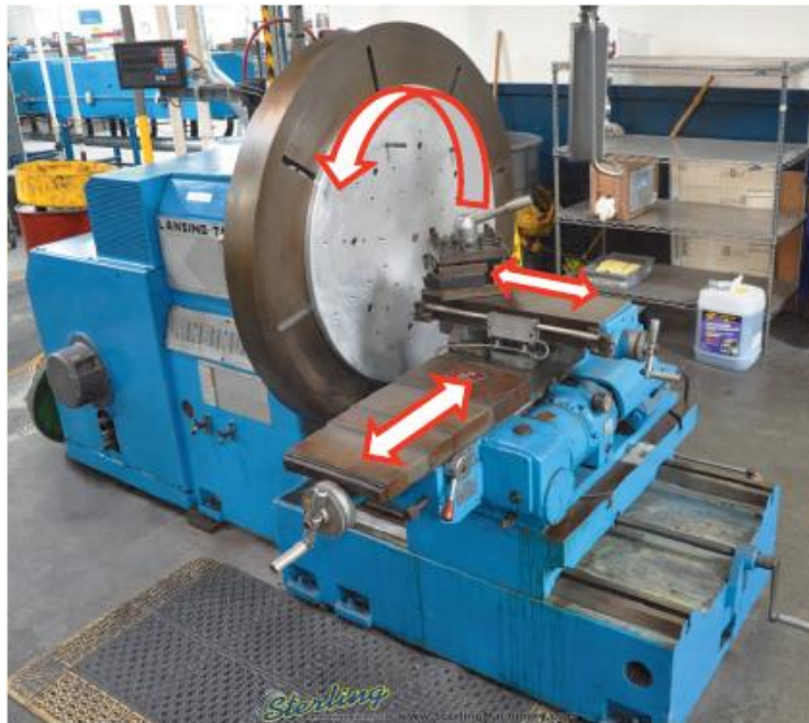
รูปที่ 1.8 หลักการทำงานของเครื่องกลึงหน้าจาน
