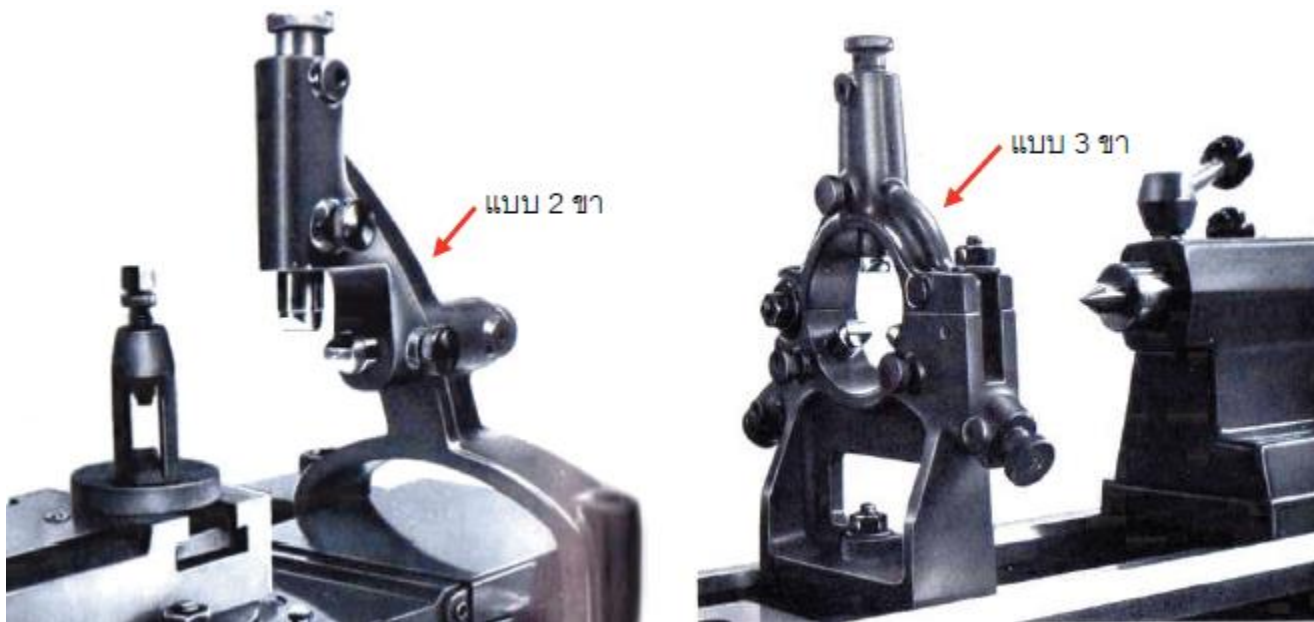
รูปที่ 1.20 รูปร่างลักษณะของก้านสะท้อนศูนย์กลางเครื่องกลึง
