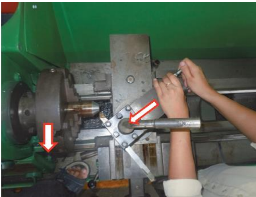
รูปที่ 2.35 การกลึงเร็วขึ้นงานโดยการป้อนแทนเลื่อนบน
