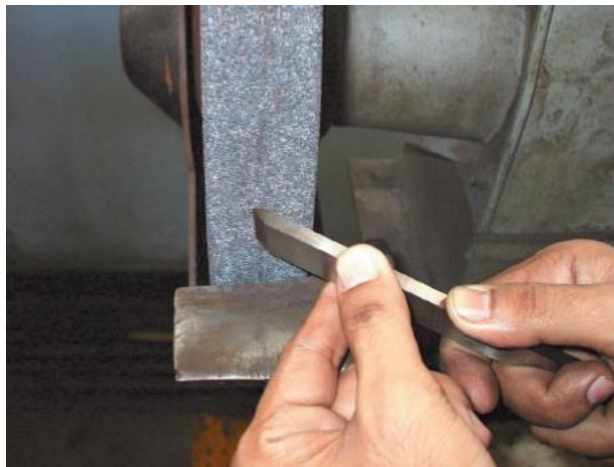
รูปที่ 2.27 วิธีการลับมุมคมตัดด้านขวามีดกลึงเกลี้ยงสามเหลี่ยม
