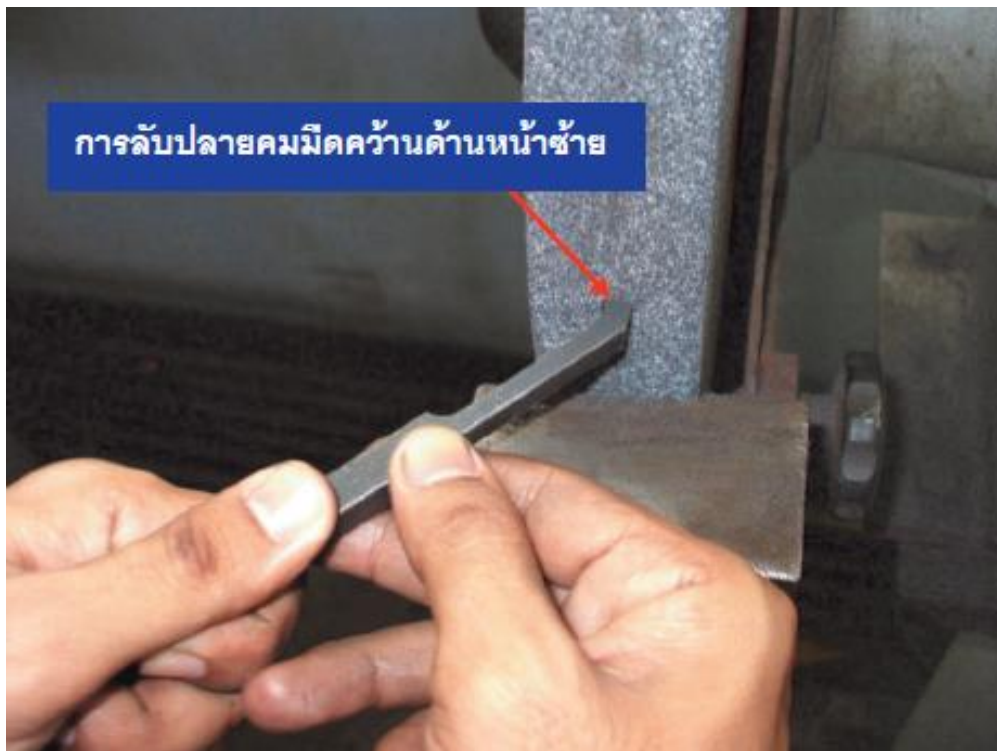
รูปที่ 2.54 วิธีการลับปลายคมตัดมีดกลึงคว้านด้านหน้าซ้าย
