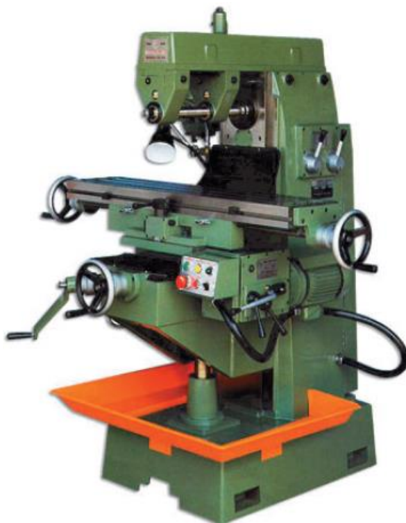
รูปที่ 3.1 รูปร่างลักษณะของเครื่องกัดเพลานอน
