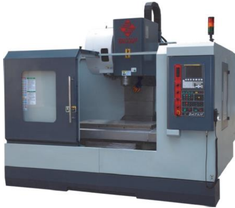
รูปที่ 3.3 รูปร่างลักษณะของเครื่องกัด CNC
