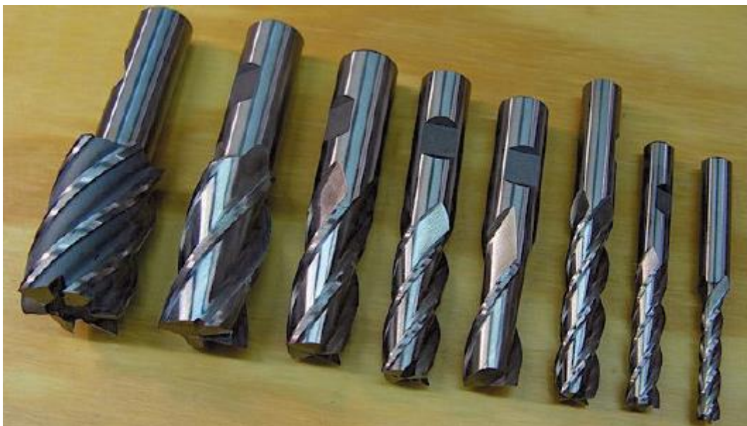
รูปที่ 3.10 รูปร่างลักษณะของดอกกัดใช้กับเครื่องกัดเพลลาตั้ง
