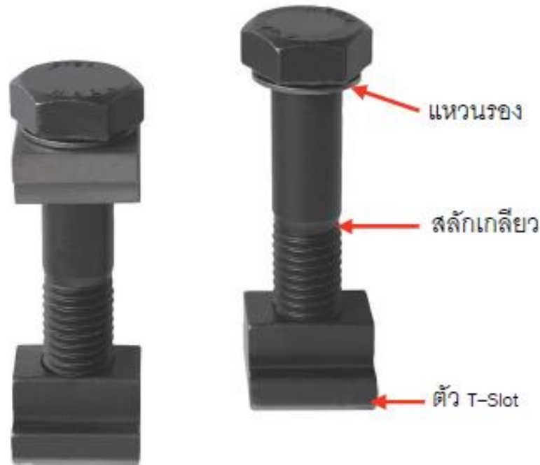
รูปที่ 3.16 รูปร่างลักษณะของชุด T-Slot ที่ใช้กับเครื่องกัด
