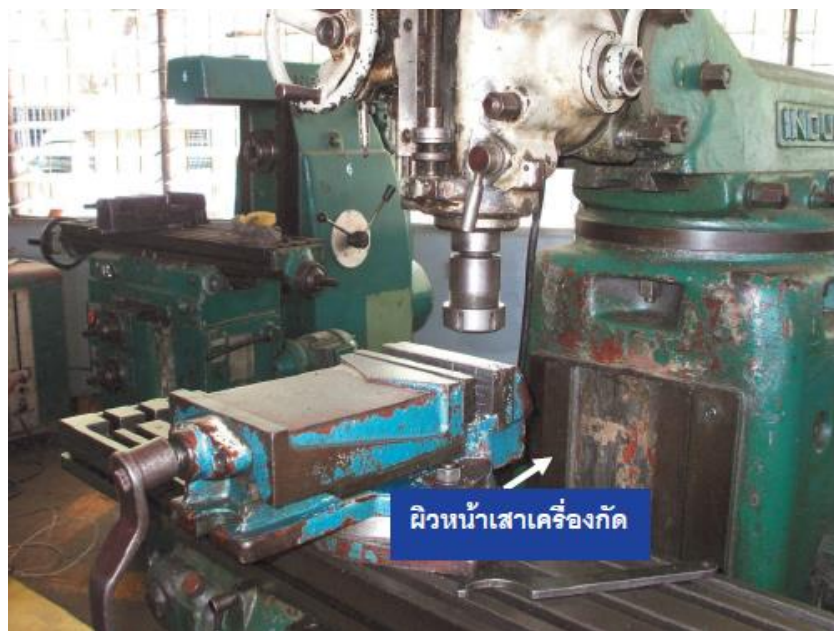
รูปที่ 3.19 การจับปากกาจับงานบนโต๊ะงานให้ปากของปากกาขนานกับผิวหน้าเสาเครื่องกัด
