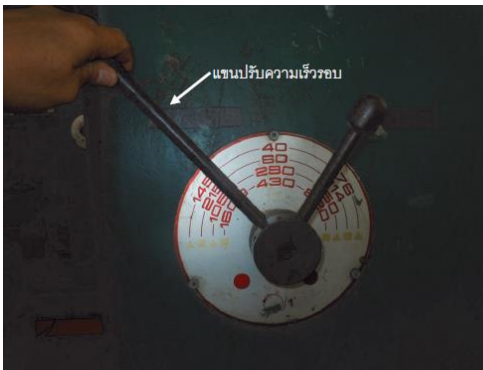
รูปที่ 4.10 ลักษณะการปรับความเร็ว รอบของเครื่องกัดเพลานอน
