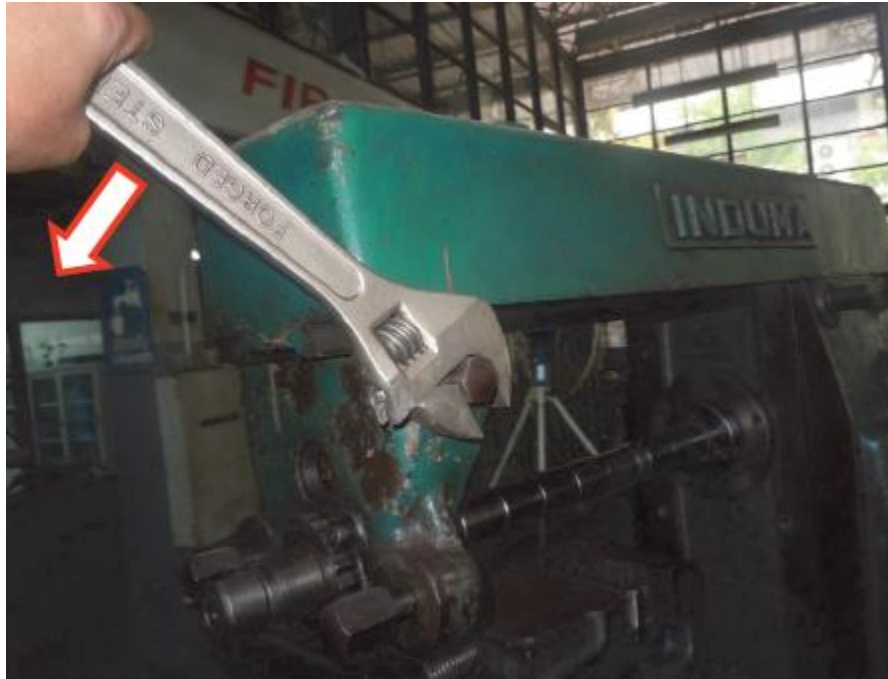
รูปที่ 4.2 ลักษณะการชั้นสกรูยึดตัวรองรับเพลาล้อกัด ออกจากแขนยื่นของเครื่องกัดเพลานอน
