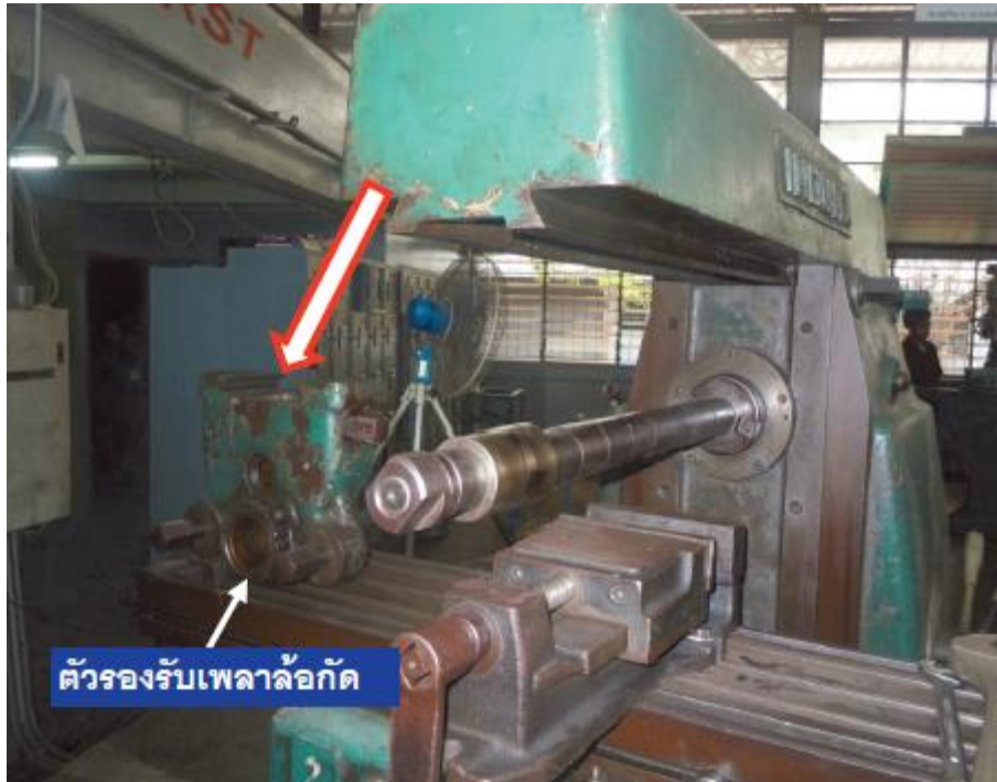
รูปที่ 4.3 การถอดตัวรองรับเพลาล้อก็ดออก ของเครื่องกัดเพลานอน
