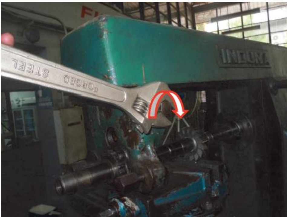
รูปที่ 4.5 ลักษณะการขันสกรูยึดตัวรองรับเพลลาล้อกัดของเครื่องกัดเพลลานอน
