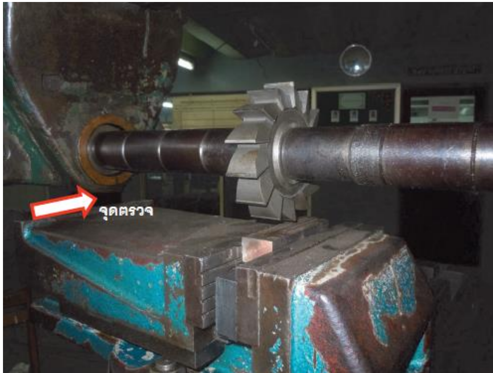
รูปที่ 4.8 ตำแหน่งจุดตรวจก่อนกัด ผิวราบด้วยเครื่องกัดเพลานอน
