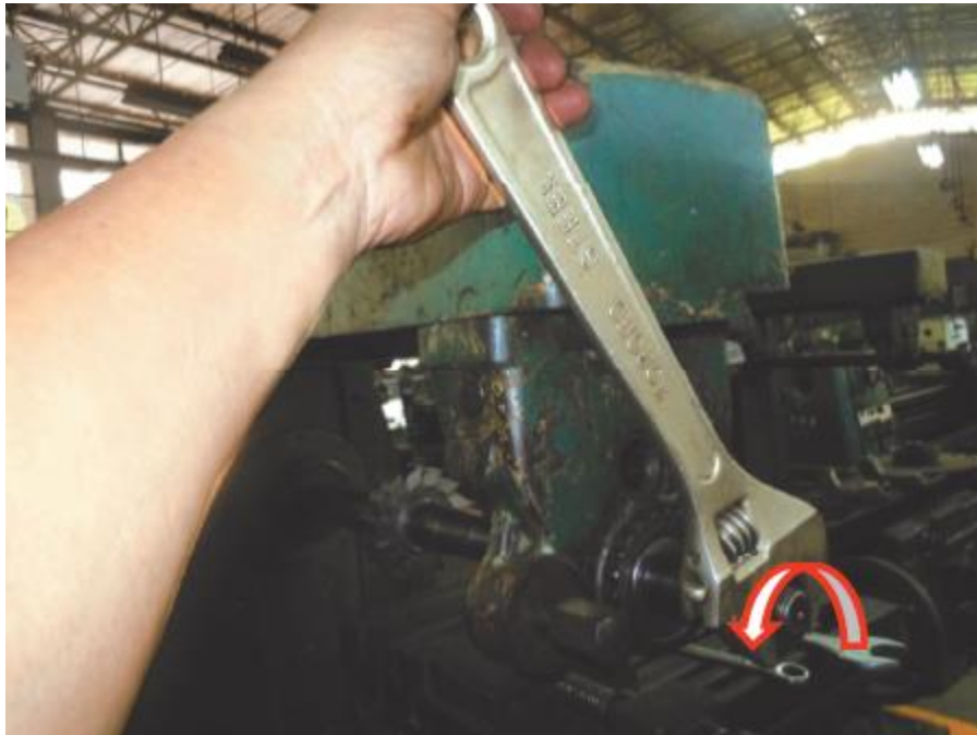
รูปที่ 4.6 ลักษณะการขันยึดแหวนเกลียวหัวเพลาล้อกัดของเครื่องกัดเพลานอน
