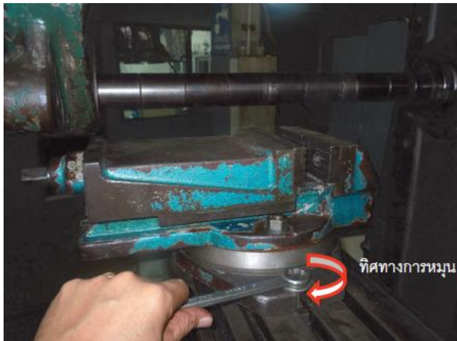
รูปที่ 4.1 ลักษณะการจับปากกาค้ำงานกับเครื่องกัดเพลานอน
