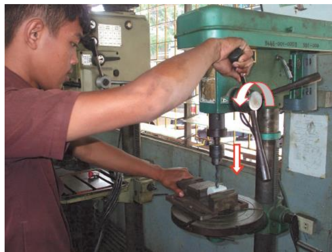
รูปที่ 5.26 วิธีการเจาะรูชิ้นส่วน ด้วยเครื่องเจาะ
