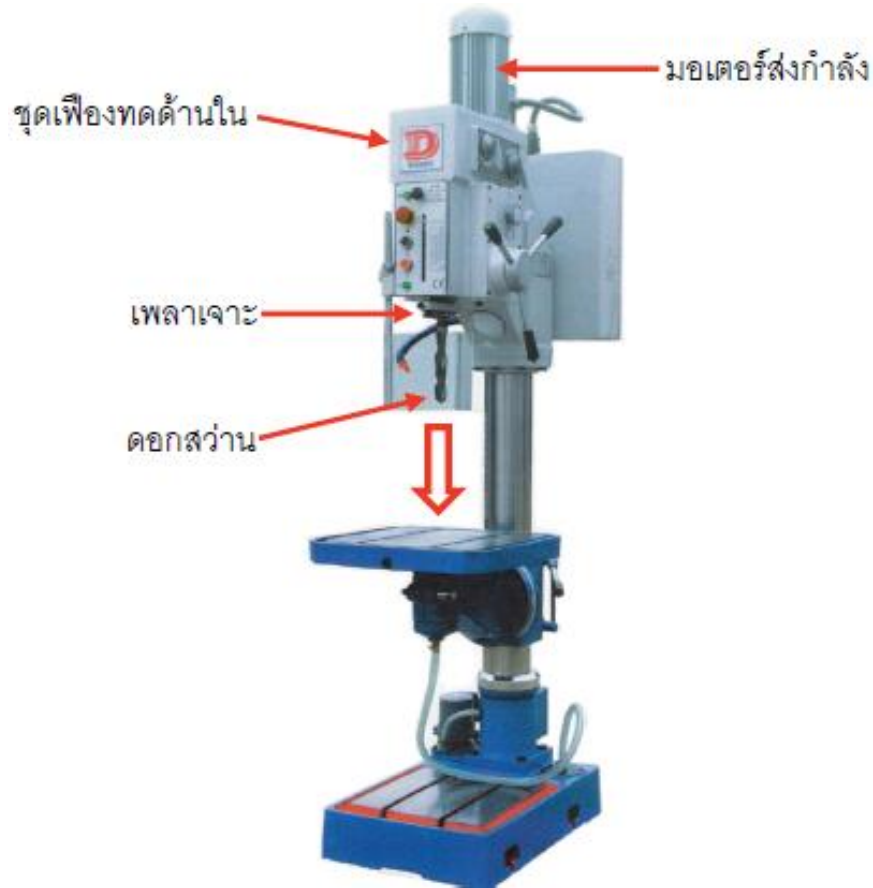
รูปที่ 5.6 หลักการทำงานของเครื่องเจาะตั้งพื้น
