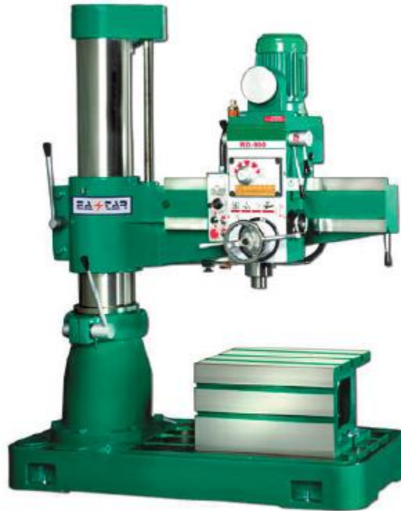
รูปที่ 5.3 รูปร่างลักษณะของเครื่องเจาะรัศมี
