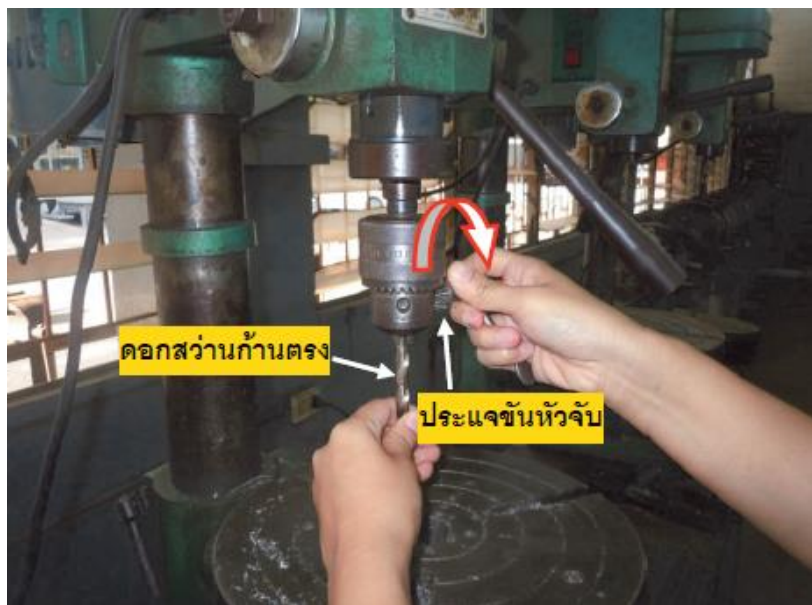
รูปที่ 5.20 วิธีการจับดอกสว่านก้านตรงด้วยหัวจับดอกสว่าน
