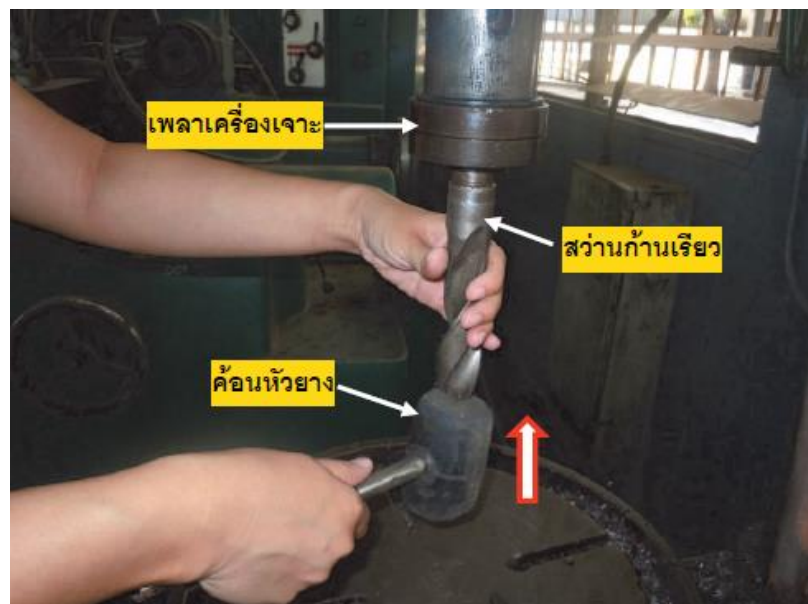
รูปที่ 5.21 วิธีการจับดอกสว่านก้านเรียวกับเพลลาเครื่อง
