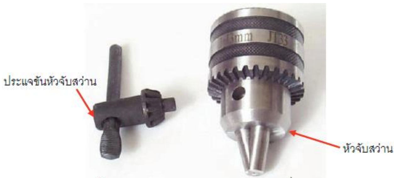
รูปที่ 5.10 รูปร่างลักษณะของหัวจับดอกสว่านที่ไม่มีก้าน
