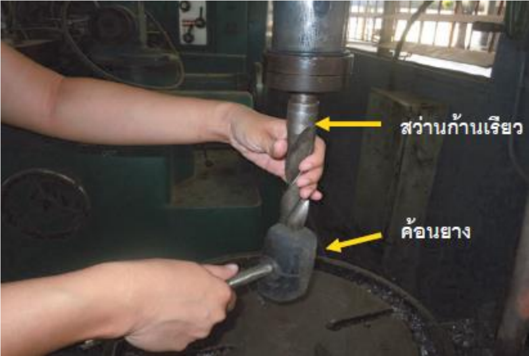
รูปที่ 6.2 การจับดอกส่วนก้านเรียบกับ เพลลาเครื่องเจาะใช้ค้อนยางช่วยตอกอัดเบา ๆ
