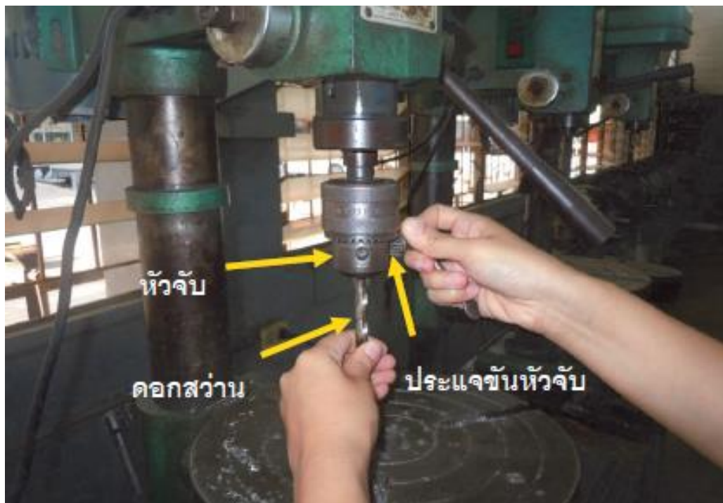
รูปที่ 6.1 การจับดอกสว่านก้านตรงกับหัวจับดอกสว่านใช้ประแจขันแน่น
