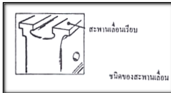
รูปที่ 1.4 สะพานแทนเครื่องของเครื่องกลึงแบบแบนเรียบ
