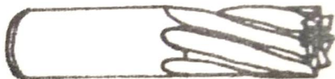
รูปที่ 3.37 ดอกกัท END MILL แบบก้านจับตรง
