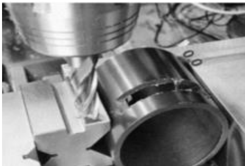
รูปที่ 2.19 การกัดร่องบนแท่งทรงกระบอกกลาง ที่มา : ว่างอักษร ผลิตชิ้นส่วนด้วยเครื่องมือกล 3
