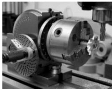
รูปที่ 2.6 การใช้หัวแบ่งช่วยในการกัดเฟืองมุมฉาก ที่มา : วังอักษร ผลิตชิ้นส่วนด้วยเครื่องมือกล 3
