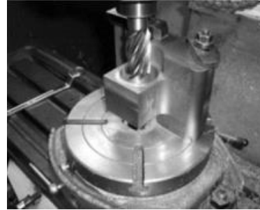
รูปที่ 2.9 การใช้หัวแบ่งโรตารีจับชิ้นงาน
