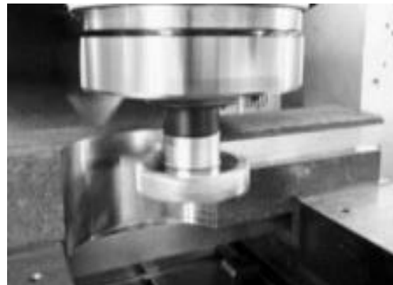
รูปที่ 2.14 การกัดชิ้นรูปโค้งเว้าในชิ้นงาน
