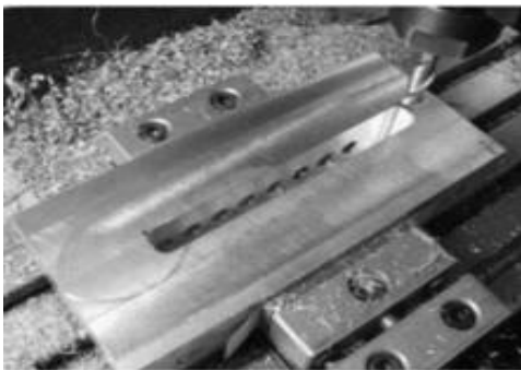
รูปที่ 2.17 การกัดโดยใช้ดอกเอ็นมิลล์ ที่มา : ว่างอักษร ผลิตชิ้นส่วนด้วยเครื่องมือกล 3
