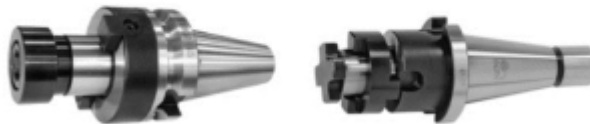
รูปที่ 2.36 แกนเพลลาจับยึดดอกกัดปาดหน้าแบบต่าง ๆ
