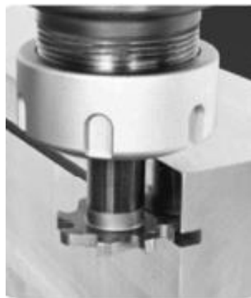
รูปที่ 2.23 การกัดร่องด้วยดอกกัด Side Milling Cutter
