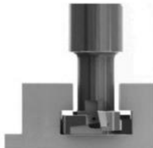
รูปที่ 2.20 การกัดร่องตัวที (T-slot) ที่มา : ว่างอักษร ผลิตชิ้นส่วนด้วยเครื่องมือกล 3
