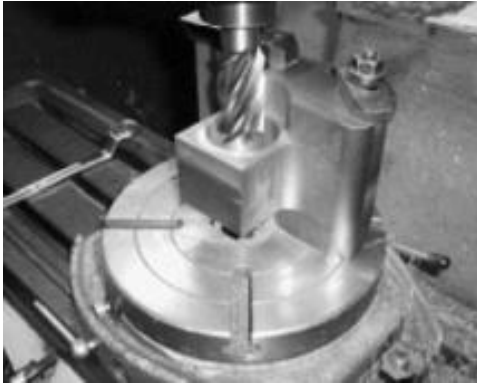
รูปที่ 2.15 การกัดขึ้นรูปคว้านรูกลม โดยใช้หัวแบบโรตารี ที่มา : ว่างอักษร ผลิตชิ้นส่วนด้วยเครื่องมือกล 3
