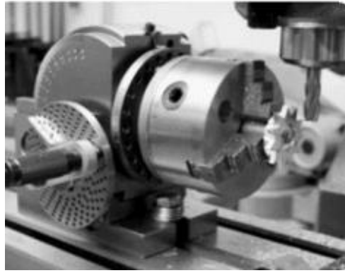
รูปที่ 2.16 การกัดขึ้นรูปเป็นรูปดาวแฉก ที่มา : ว่างอักษร ผลิตชิ้นส่วนด้วยเครื่องมือกล 3
