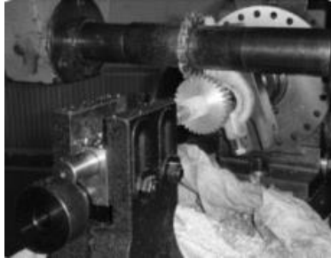
รูปที่ 2.3 การใช้หัวแบ่งช่วยในการกัดเฟืองตรง ที่มา : วังอักษร ผลิตชิ้นส่วนด้วยเครื่องมือกล 3
