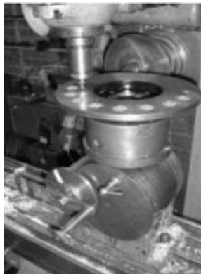
รูปที่ 2.7 การใช้หัวแบ่งช่วยในการเจาะรู ที่มา : วังอักษร ผลิตชิ้นส่วนด้วยเครื่องมือกล 3
