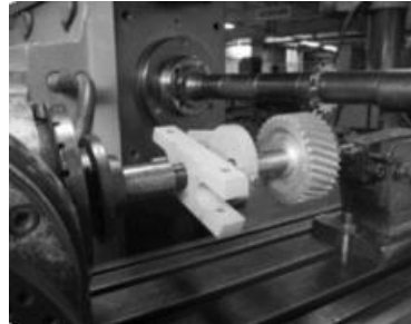
รูปที่ 2.4 การใช้หัวแบ่งช่วยในการกัดเฟืองเฉียง ที่มา : วังอักษร ผลิตชิ้นส่วนด้วยเครื่องมือกล 3
