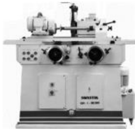
รูปที่ 6.1 เครื่องเจียรระโนทรงกระบอกแบบธรรมดา (Plain Grinding Machine)
