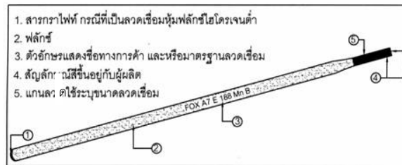
รูปที่ 1.2.3 ส่วนประกอบของลวดเชื่อม
