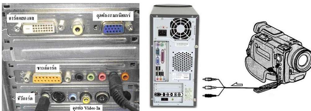
รูปจุดต่อสัญญาณภาพเข้าเครื่องคอมพิวเตอร์
