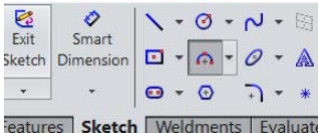
รูปที่ 23 : การเลือกใช้งานคำสั่ง 3 Point Arc
