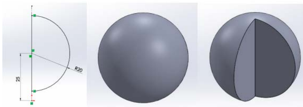
รูปที่ 1 : ตัวอย่างวัตถุที่ถูกสร้างขึ้นด้วยคำสั่ง Revolved Boss/Base
