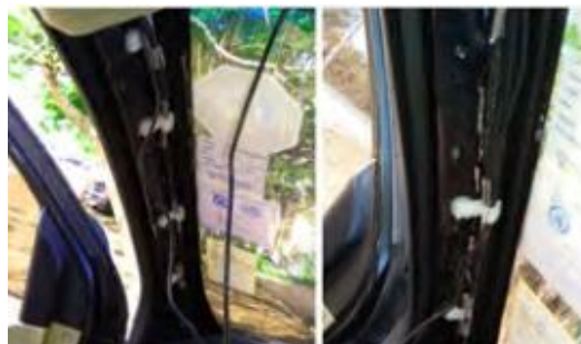
รูปที่ 4 เก็บสายไฟตรงเสา A
