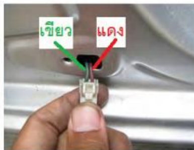
ปลั๊กสวิตช์ รูปที่ 4 ไล่สายไฟ
