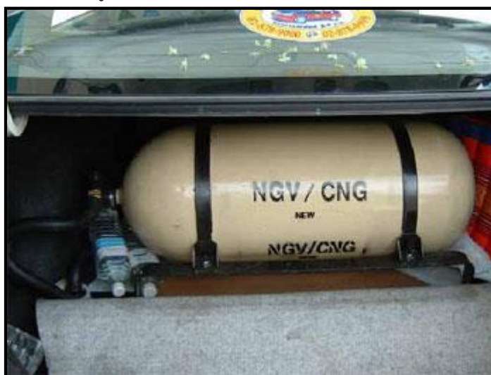
รูปที่ 4.6 การติดตั้งถังก๊าซในรถยนต์ ()
